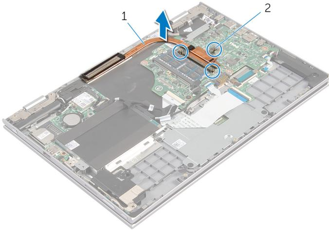
**1** dissipatore di calore
